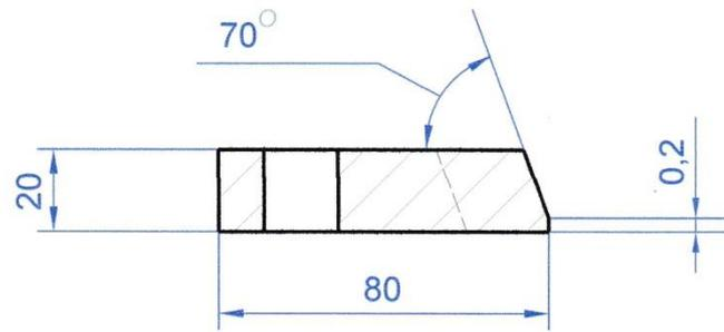
Допускается переточка по размеру 80 - 6 мм.
